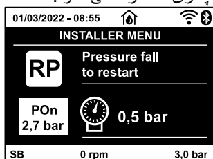
شکل 18.2: تنظیم حداقل مقدار فشار مورد نیاز جهت استارت مجدد (2)
