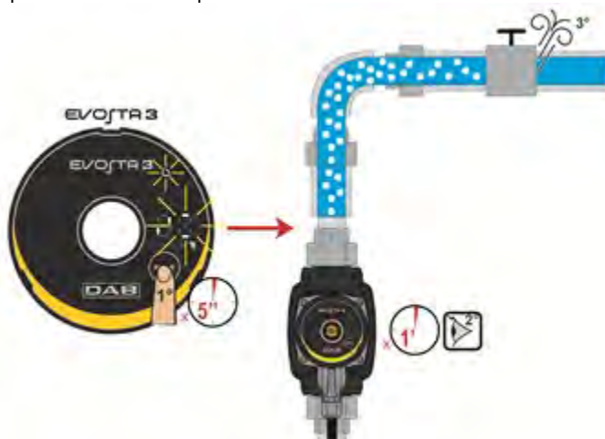
Figura 9: Sfiato automatico della pompa
